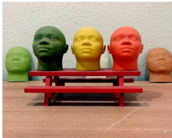
Abbildung 7. Durch pulverbasierten 3D-Druck hergestellte schnelle Prototypen. Quelle: S Zillayali, CC BY-SA 3.0 < https://creativecommons.org/licenses/by-sa/3.0/ >, via Wikimedia Commons
