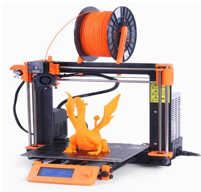
Abbildung 5. PRUSA i3 MK2 FDM-Drucker (Prusa Research, Prag, Tschechische Republik) mit Spule und einem fertigen Objekt. Bildquelle: Wikimedia Commons, http://reprap.org/wiki/File:Prusai3-MK2.jpg .
