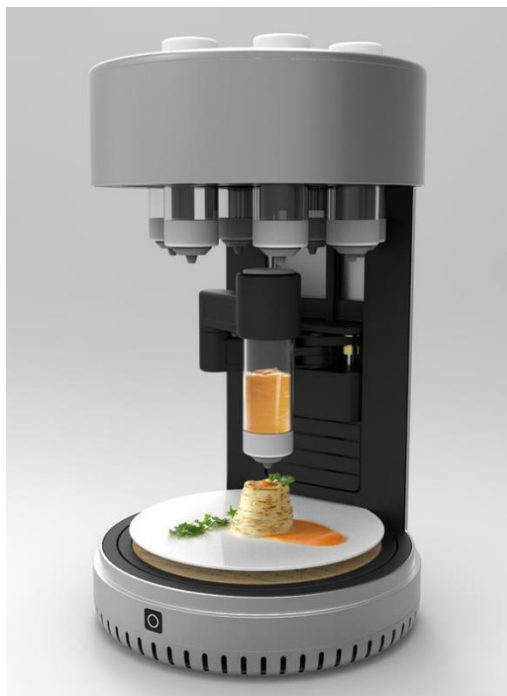
Εικόνα 6. Εκτύπωση εξώθησης για τη βιομηχανία τροφίμων. Πηγή: Grup de recerca de la Universitat de Columbia - https://www.creativemachineslab.com/digital-food.html , CC BY-SA 4.0, https://commons.wikimedia.org/w/index.php?curid=84202502
